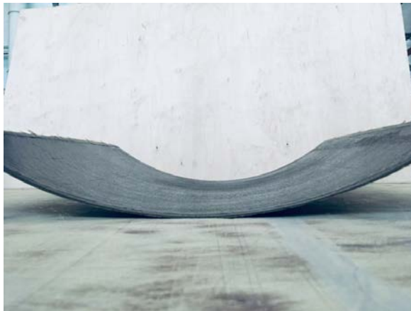
Рис.1. Изготовленная пластина из ВКУ-30 (а – схема укладки, б – заготовка на оснастке, в – изготовленная пластина).
