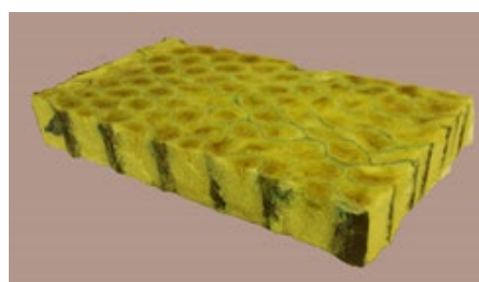
Рис.2. ППУ, армированный БП с размерами ячеек 15 мм.
