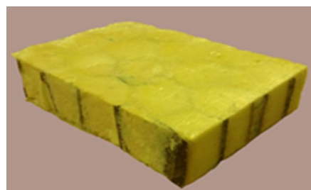
Рис.4. ППУ армированный БП с размерами ячеек 30 мм.
