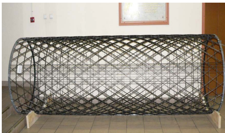
Рис.1. Фотография переходного отсека.
