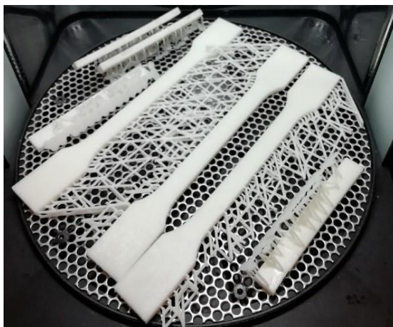
Рис.3. Образцы, прошедшие процедуру доотверждения материала в сушильной камере.
