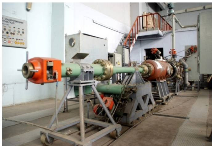
Рис.2. Воздушная газовая пушка, используемая для метания ударника.
