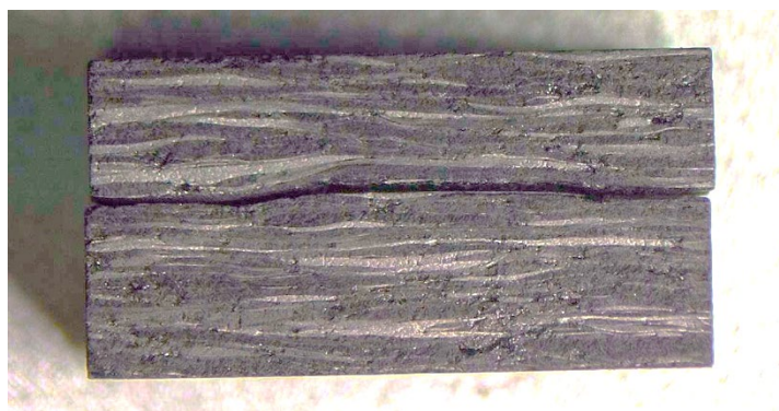
Рис.12. Линия фронта разрушения материалов на основе пековой матрицы после испытания на сдвиг.
