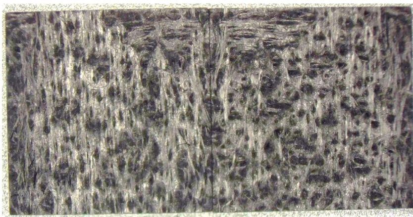
Рис.11. Поверхности излома образца из материала с пироуглеродной матрицей после испытания на сдвиг.
