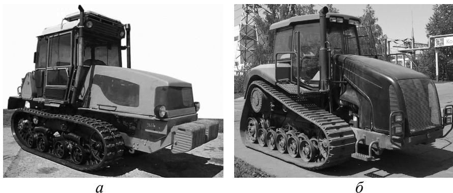
Рис.1. Сельскохозяйственные тракторы с РАГ: а – ВТ-150 с овальным гусеничным обводом; б – Агромаш-Руслан с треугольным гусеничным обводом.
