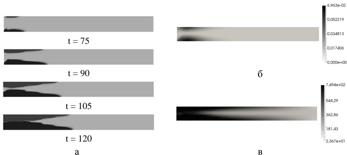
Рис.3. Движение фронта (а), распределение интенсивности пластических деформаций (б) и напряжений (в) для задачи об изгибе балки.
