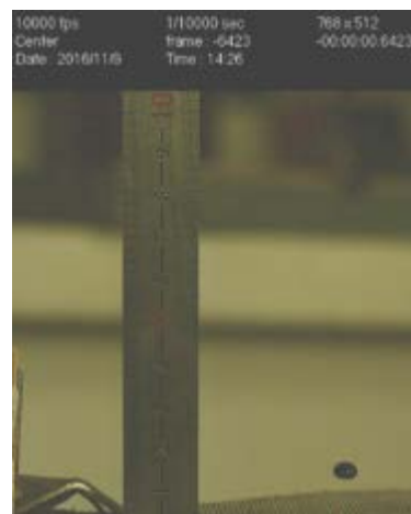
Рис.2. Кадр высокоскоростной съемки, сделанной для оценки состояния капли и скорости падения.
