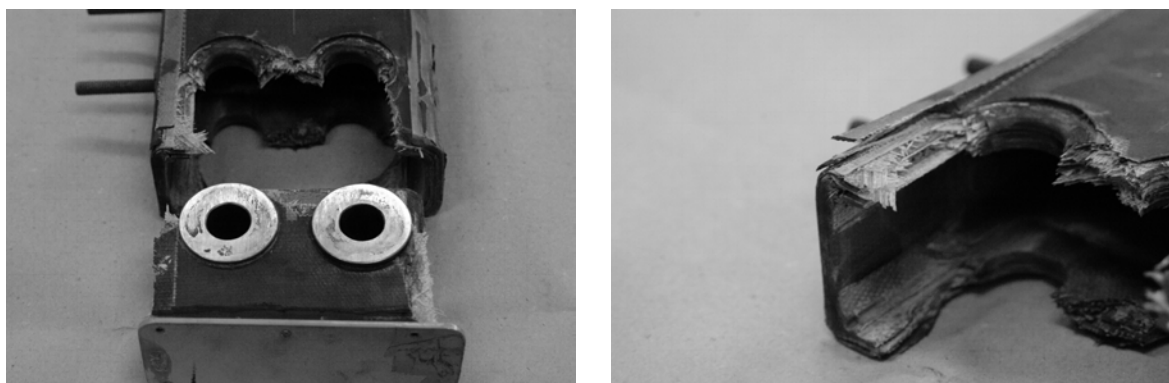
Рис.1. Комель лопасти, разрушенный при стендовых испытаниях.
