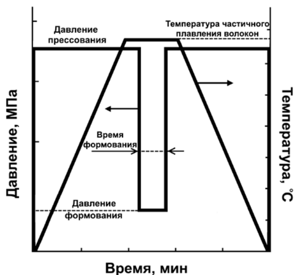
Рис.5. Схема термического прессования СВМПЭ волокон.
